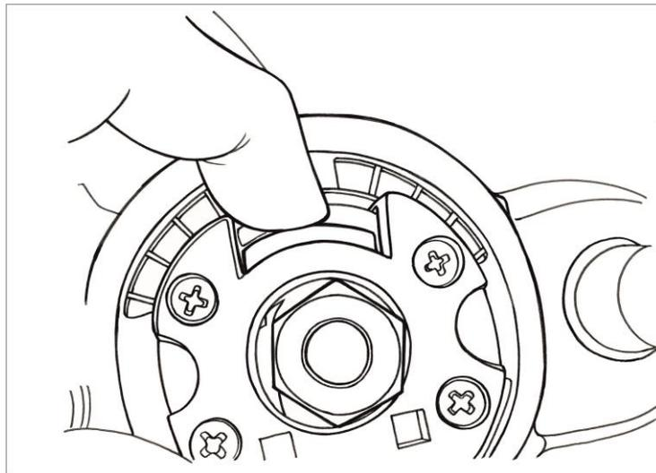
Рис.2 Блокировка шпинделя
