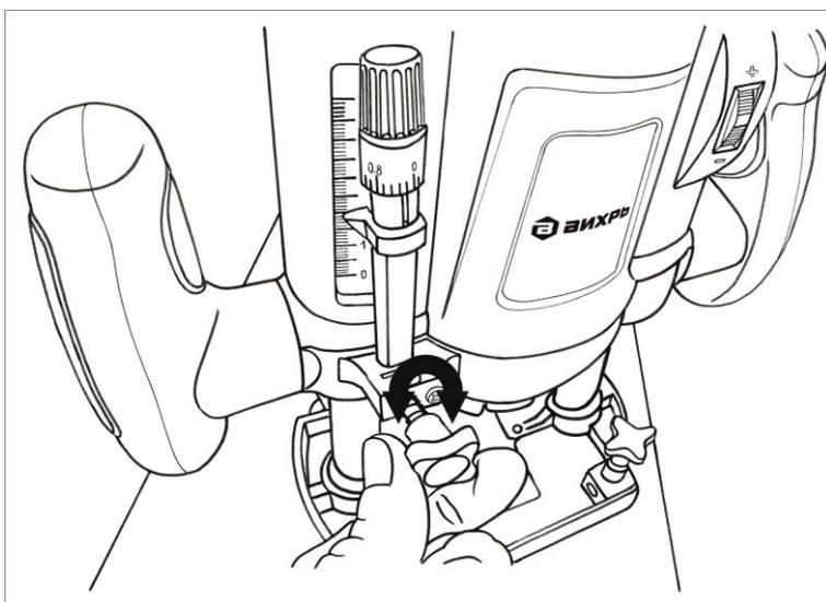
Рис.7 Фиксатор регулировки
