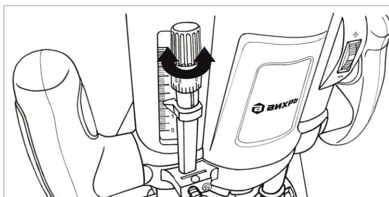
Рис.5 Точная регулировка
