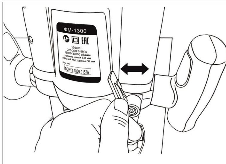
Рис.7 Фиксирующий рычаг
